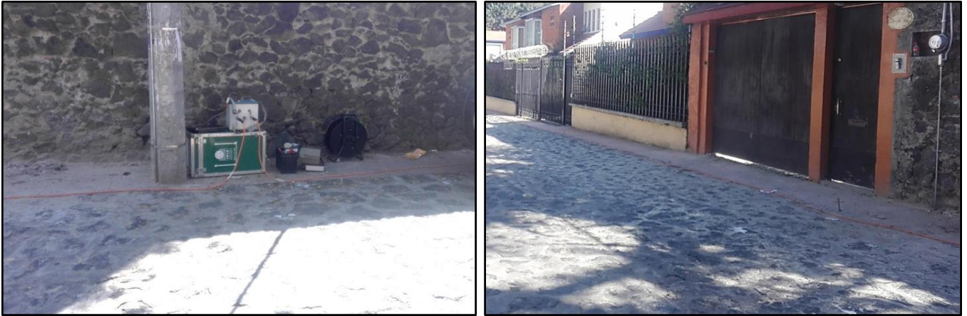
Figura 10. Fotografías donde se observan electrodos colocados en contacto con el terreno (19.274733° N, 99.134417° W. Calle: La Joya).
