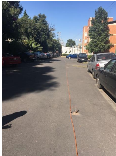
Figura 10. Fotografías donde se observan electrodos colocados en contacto con el terreno (19.2584° N, 99.1204° W. Retorno).
