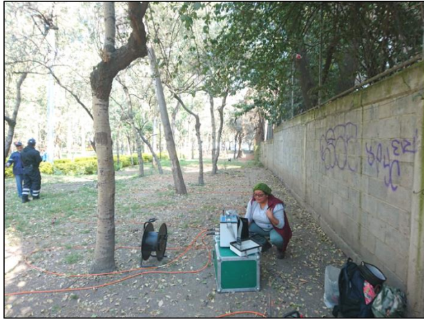
Figura 10. Fotografías donde se observan electrodos colocados en contacto con el terreno (19.28019° N, 99.13318° W. Calle: Rincón Amor).
