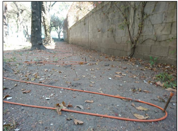
Figura 10. Fotografías donde se observan electrodos colocados en contacto con el terreno (19.28019° N, 99.13318° W. Calle: Rincón Amor).
