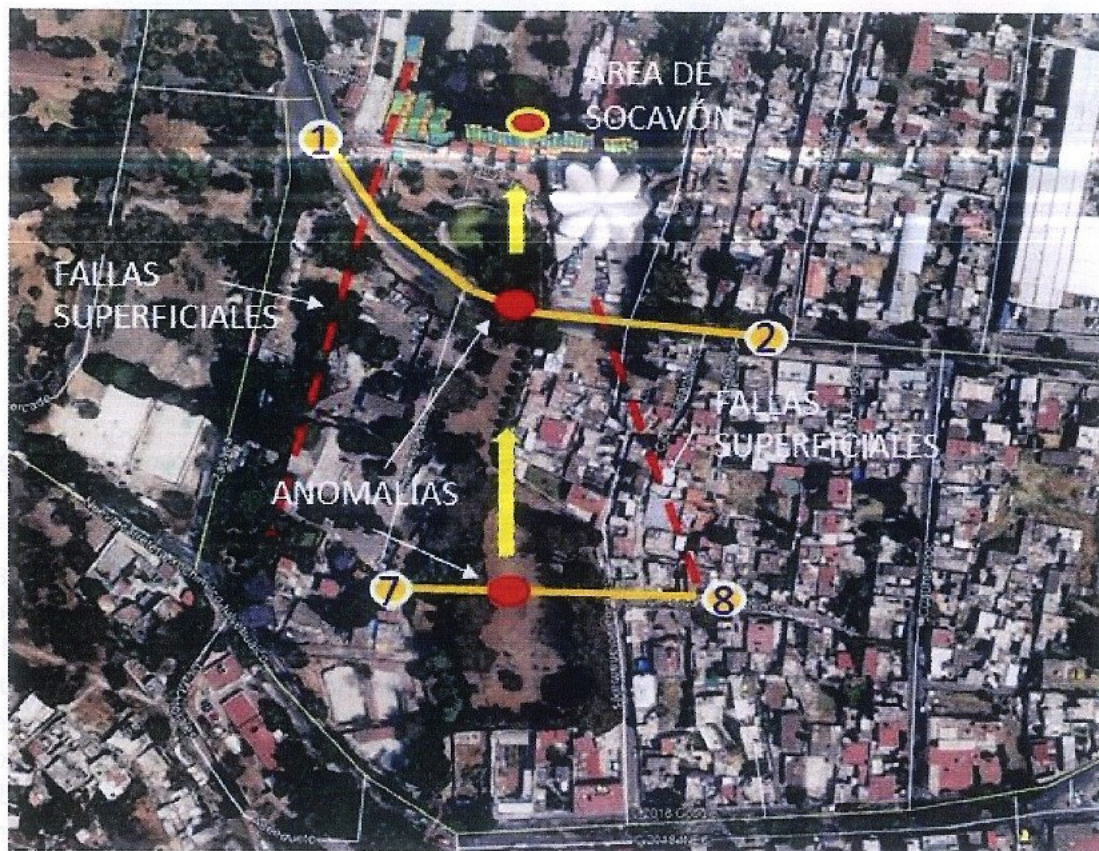
Figura 11. Conexión hipotética entre la posición de las anomalías de resistividad encontradas en los perfiles procesados; las características de profundidad y geometría soportan esta hipótesis.
