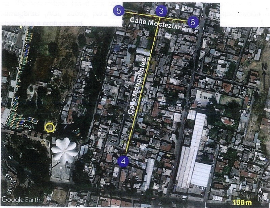
Figura 8. Imagen de Google-Earth (2017). Posición de las líneas 3-4 y 5-6. La longitud de cada perfil es la misma que la mostrada en la Figura 6. El círculo amarillo muestra el punto del socavón en el canal. Los puntos rojos indican la posición de los electrodos
