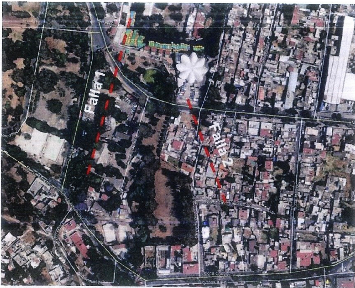
Figura 4. Imagen de Google-Earth (2017). Se observan dos alineamientos estructurales que corresponden a un sistema de fallas superficiales. La falla 1 ha afectado severamente la Casa de Bombas hacia el sur. La falla 2 atraviesa la zona urbana y se dirige directamente al embarcadero. Actualmente se pueden observar daños muy severos a casas habitación e infraestructura urbana debido a este rasgo geológico.
