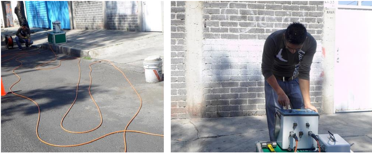
Figura 13. Fotografía que muestra la colocación de la consola del resistímetro Syscal Pro durante el levantamiento (19.2903° N; 99.0616° W. Calle: Océano).
