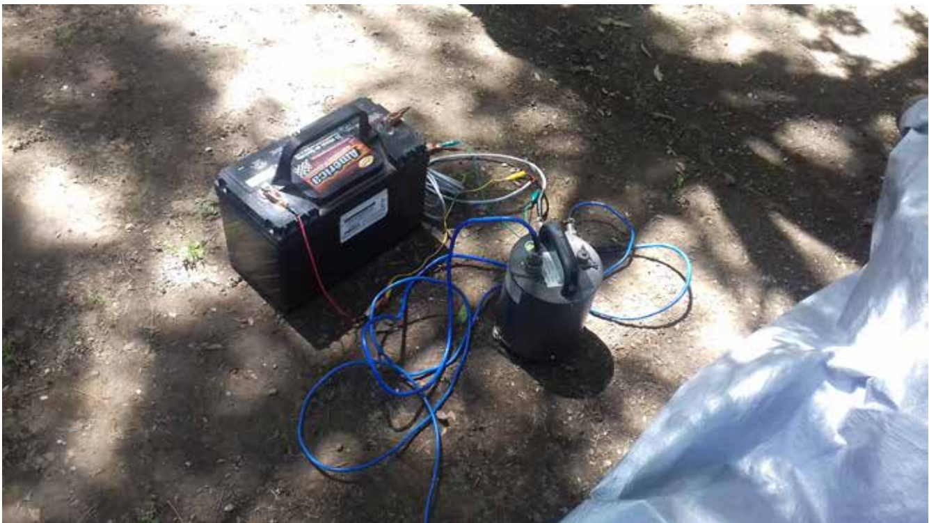
Figura 5.2. Sensor triaxial de la marca Guralp utilizado para la adquisición de datos en el monitoreo de vibración ambiental.
