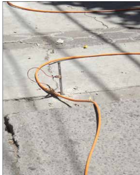
Figura 11. Fotografías donde se observan electrodos colocados en contacto con el terreno y el equipo funcionando (19. 215225° N, 98. 978804° W. Calle: 5 de mayo).
