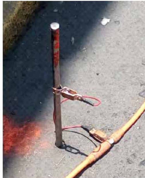
Figura 11. Fotografías donde se observan electrodos colocados en contacto con el terreno (19.217411°N, 98.994801° W. Calle:).
