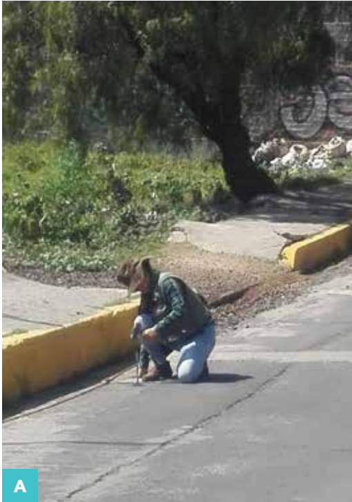
Figura 10. A).- Fotografía donde se observan los electrodos colocados en el terreno. B).- Equipo Syscal utilizado para la toma de resistividades (19.2584° N, 99.1204° W. Retorno).
