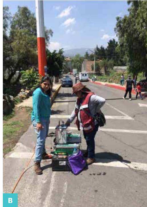
Figura 10. A).- Fotografía donde se observan los electrodos colocados en el terreno. B).- Equipo Syscal utilizado para la toma de resistividades (19.2584° N, 99.1204° W. Retorno).
