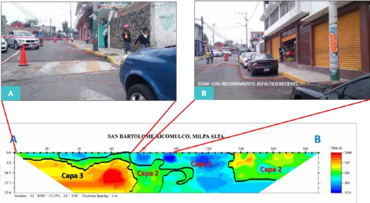
Figura 18. Imagen Resistiva y su relación con respecto al número de electrodos: A) Muestra los primeros 16 electrodos (0 a 72 m) y su ubicación en campo. B) Muestra los electrodos del 16 al 24 (72 a 98 m) el electrodo 24 se encuentra sobre una zona que presenta un recubrimiento asfáltico reciente (19.208708° N, 99.067013° W. Calle: Francisco I. Madero).
