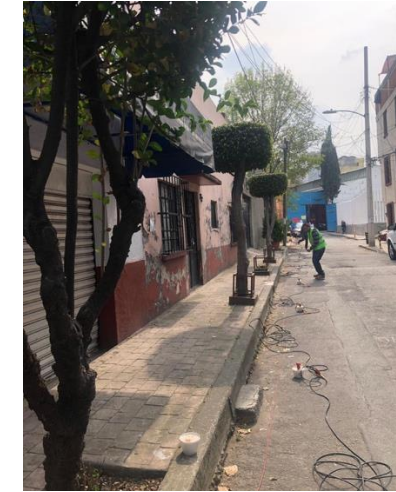
Figura 5. 14. Levantamiento del perfil de Dispersión de Ondas Sísmicas Superficiales (MASW) sobre la Cerrada Gobernador Ignacio Esteva.
