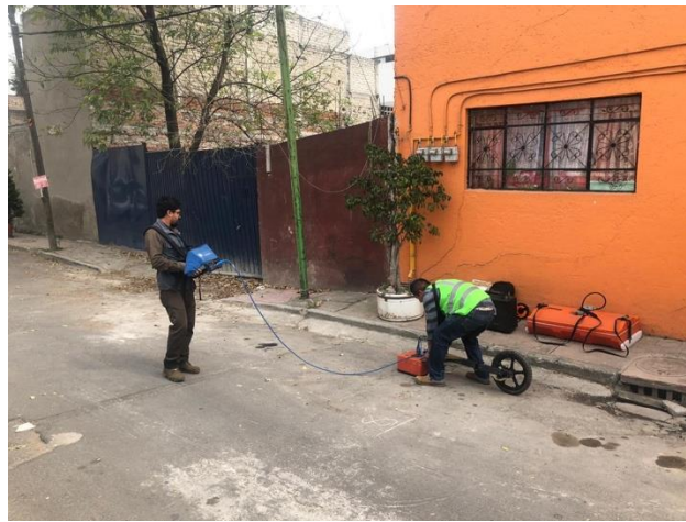
Figura 5. 16. Levantamiento del perfil de Radar de Penetración Terrestre (RPT) sobre la Cerrada Ignacio Esteva, usando antena de 100 MHz y 400 MHz.
