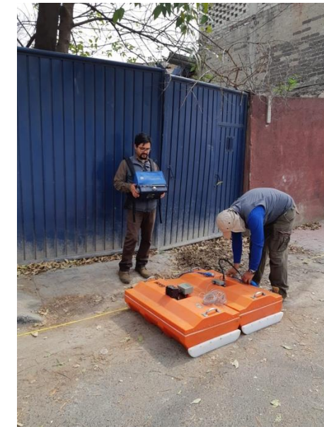
Figura 5. 19. Levantamiento del sondeo CMP-3, usando Radar de Penetración Terrestre (RPT) sobre La Cerrada Gobernador Ignacio Esteva.
