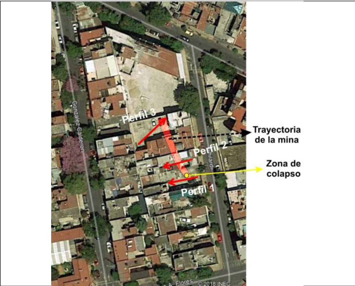
Figura 5.29. Croquis que representa a la zona de colapso de la mina. Zona roja punteada indica la trayectoria inferida por la influencia de la mina, punto amarillo indica la zona del colapso verificado en campo
