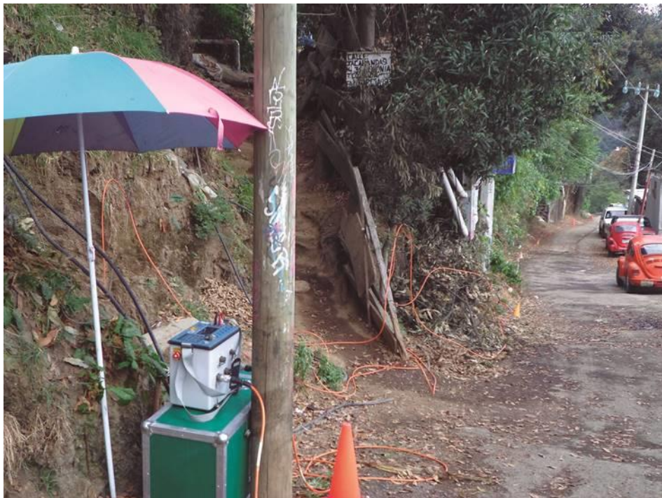
Figura 10. Fotografía que muestra la consola SYSCAL Pro y el tendido del cable durante el levantamiento de la TRE (19.2702° N, 99.2452° W. Calle: Jacarandas).
