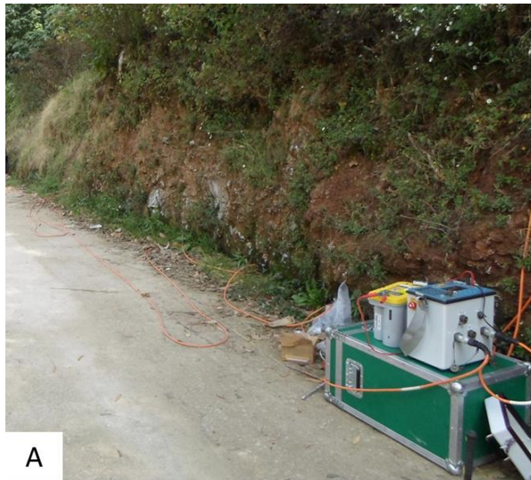
Figura 12. A) Colocación de la consola del equipo Syscal Pro durante el levantamiento. B) Electrodo colocado en contacto con el material del suelo. (19.2825° N; 99.2459° W. Calle: Ojo de Agua).
