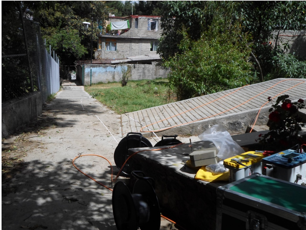
Figura 12. Fotografía que muestra el tendido del cable y los electrodos al realizarse el levantamiento (19.3161° N, 99.2527° W. Calle: Sin nombre oficial, colonia Atacaxco).
