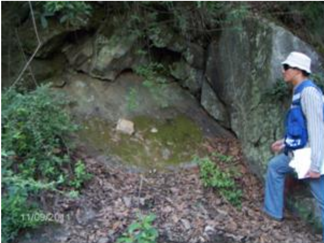
Afloramiento de roca que presenta planos de deslizamiento a favor de la pendiente.
