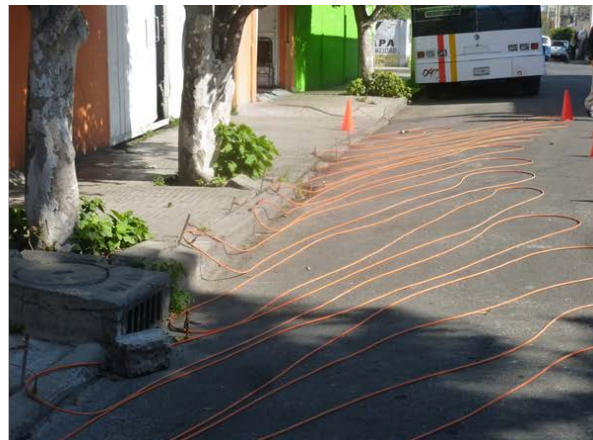
Figura 17. Fotografía que muestra el tendido del cable durante el levantamiento (19.0021° N; 99.0143° W. Calle: Emilio Madero).
