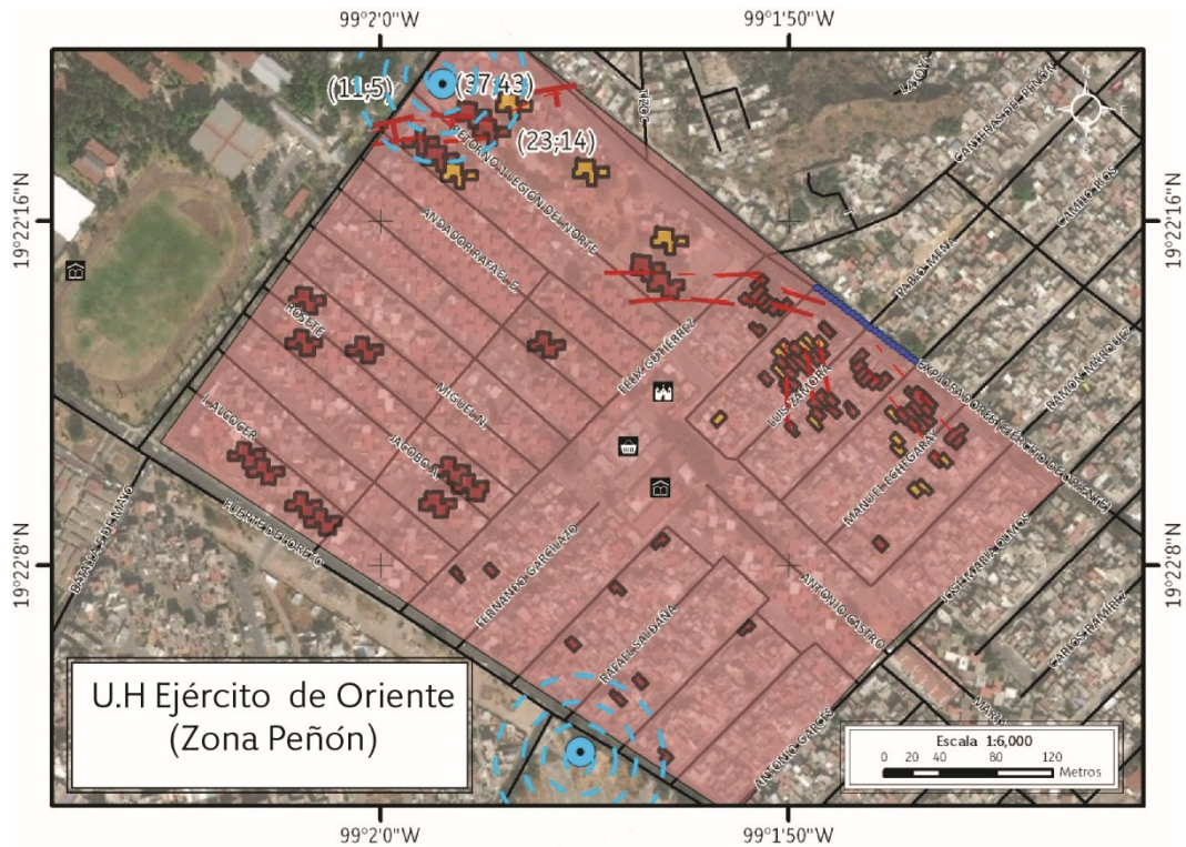
Figura 34. Imagen de satélite donde se localizan la cartografía de las estructuras de hundimiento (líneas rojas) el polígono de peligro (área de color rosa), lotes con vulnerabilidad alta (cuadros rojos), lotes vulnerables (color amarillo), la tomografía eléctrica (puntos azules) y los pozos con la zona de influencia del cono de abatimiento (circulo azul relleno y líneas azules punteadas). La dirección de las estructuras de hundimiento no se dirigen al cono de abatimiento.
