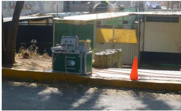
Figura 17. Fotografía que muestra la colocación de la consola del resistímetro Syscal Pro durante el levantamiento (19.3702 ° N, 99.0297° W. Calle: Exploradores (Ejército de Oriente)).
