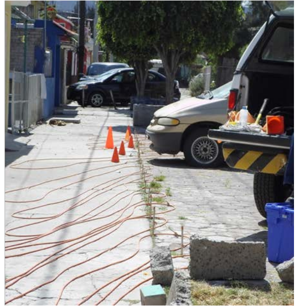
Figura 16. Colocación de los electrodos y el cable durante el levantamiento (19.3626° N, 98.9983° W. Calles: Anselmo de Adán y Niño Artillero).
