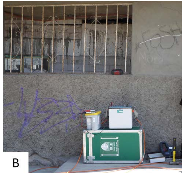
Figura 17. A) Electrodos colocados en contacto con el material del suelo .B) Colocación de la consola del equipo Syscal Pro durante el levantamiento (19.3626° N, 98.9983° W. Calles: Anselmo de Adán y Niño Artillero).
