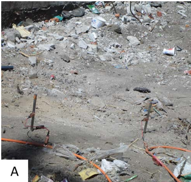
Figura 17. A) Electrodos colocados en contacto con el material del suelo .B) Colocación de la consola del equipo Syscal Pro durante el levantamiento (19.3626° N, 98.9983° W. Calles: Anselmo de Adán y Niño Artillero).
