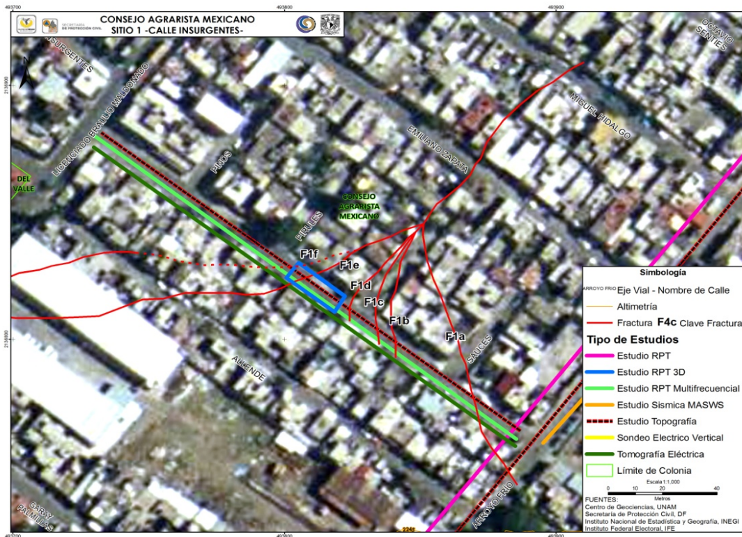
Figura. 29. Distribución del fracturamiento y de los estudios de prospección geofísica en el Sitio de la Calle de Insurgentes.
