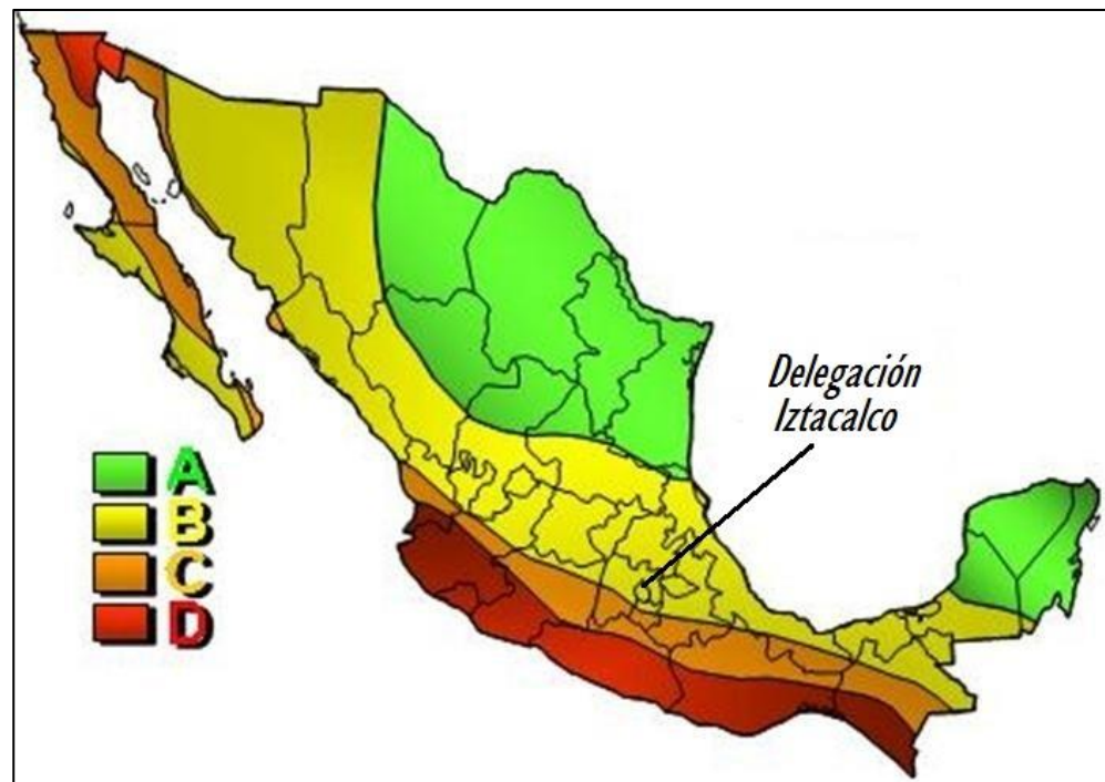
Figura 5.1.2.1 Regionalización sísmica de la República Mexicana (CFE, 2008). A: no se han reportado sismos en los últimos 80 años; B y C: sismos no tan frecuentes, son zonas afectadas por altas aceleraciones que no sobrepasan el 70% de la aceleración de la gravedad; D: se han reportado grandes sismos históricos, la ocurrencia de sismos es muy frecuente y las aceleraciones del suelo pueden sobrepasar el 70% de la aceleración de la gravedad.
