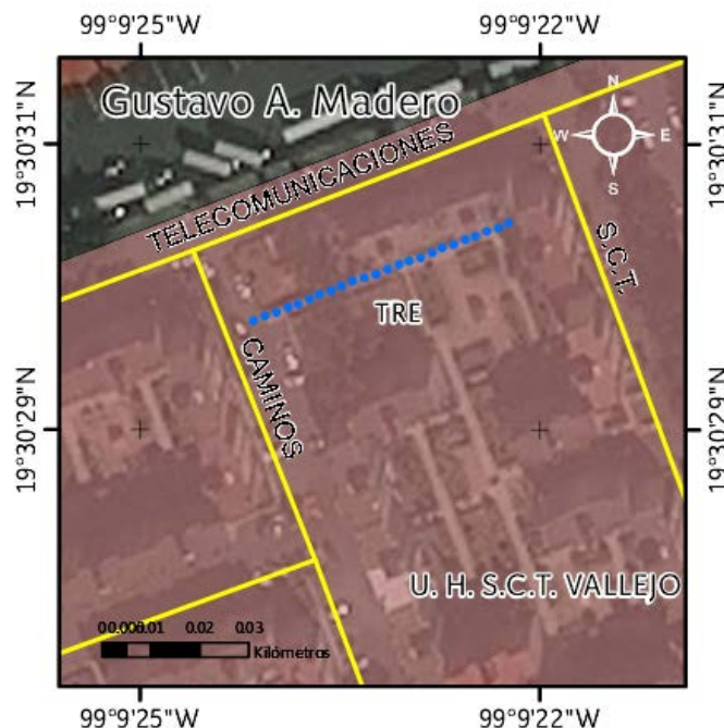
Figura 1. Croquis de localización del sitio con riesgo U. H. S. C. T. Vallejo y localización de la TRE (los puntos en color azul marcan la ubicación de los electrodos).
