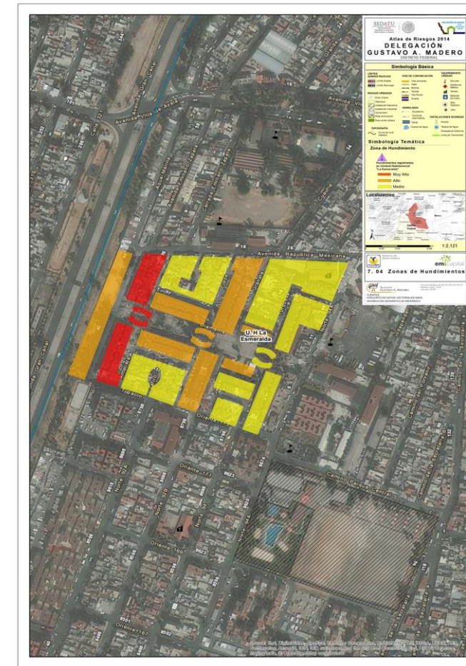
Figura 5.1.854. Mapa de peligro por hundimientos Colonia Unidad Habitacional la Esmeralda. (Calle Agua Marina)
