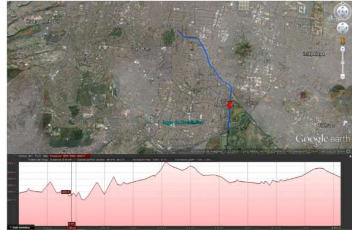
Ilustración 98. Perfil de elevación del Canal Nacional.
