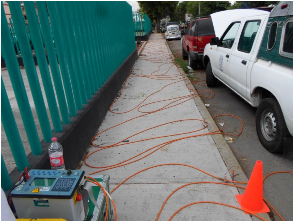
Figura 12. Se muestra el tendido del cable y la consola SYSCAL PRO durante el levantamiento (19.4851° N; 99.1727° W. Calle: Soledad).
