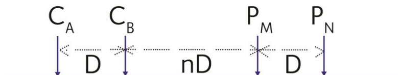
Figura 2. Disposición de los electrodos de corriente ( C_A , C_B ) y los electrodos de potencial ( P_M , P_N ) ( ELECTRE Pro software Help , Iris Instruments, 2012).
