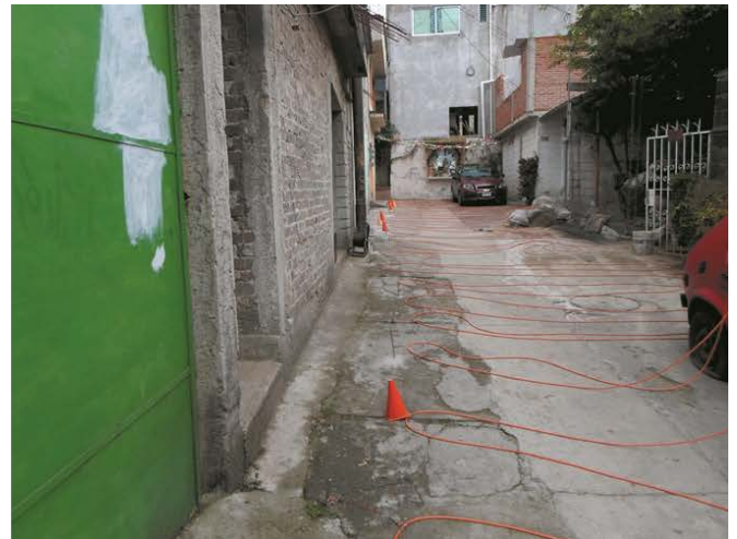
Figura 13. Fotografías que muestran los electrodos durante el levantamiento en el sitio con riesgo Tlacoyaque (19.3181° N, 99.2658° W. Calle: Cerrada de la Cruz).
