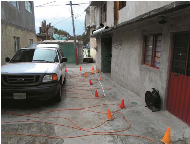
Figura 13. Fotografías que muestran los electrodos durante el levantamiento en el sitio con riesgo Tlacoyaque (19.3181° N, 99.2658° W. Calle: Cerrada de la Cruz).
