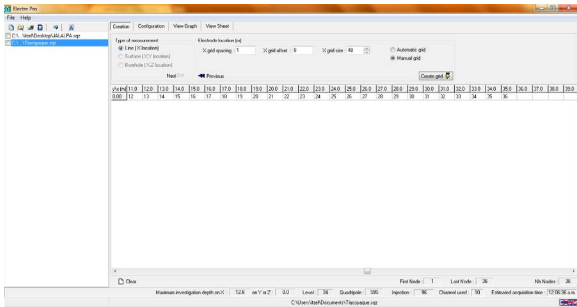
Figura 11. Ventana de asignación de separación entre electrodos (ELECTRE Pro software, Iris Instruments, 2012).
