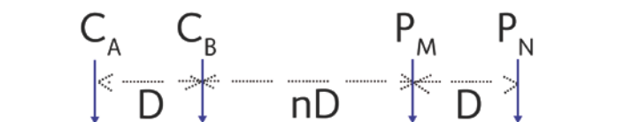
Figura 2. Muestra la disposición de los electrodos en campo, donde se nota el espaciamiento de C_A con respecto a los demás electrodos. (ELECTRE Pro software Help, Iris instruments).
