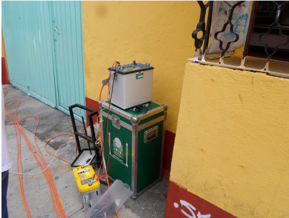
Figura 8. Se observa la consola SYSCAL Pro y el tendido del cable sobre la calle durante el levantamiento (19.3815° N; 99.2462° W. Calle: Asperillas).
