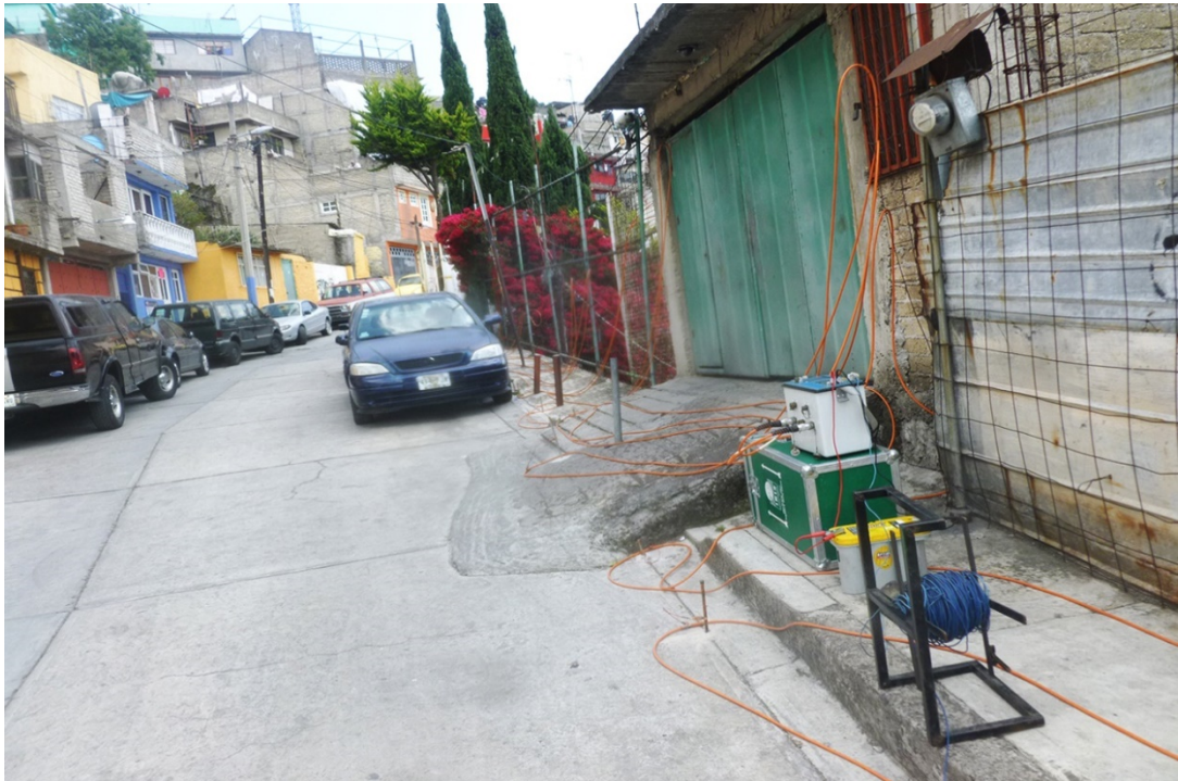
Figura 9. Se observa el tendido del cable y el instrumento SYSCAL PRO, calle arriba (19.3779° N; 99.2336° W. Calle: Paseo Lomas de Jalalpa).
