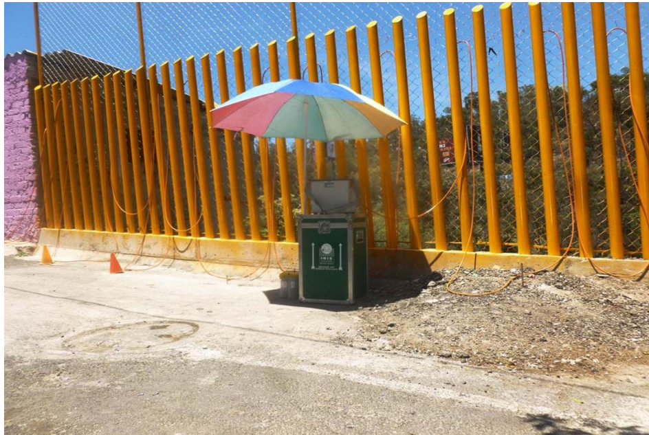
Figura 9. Fotografía donde se observa la consola SYSCAL Pro y el tendido del cable sobre la calle durante el levantamiento (19.3815° N, 99.2462° W. Calle: Barranca La Morena).
