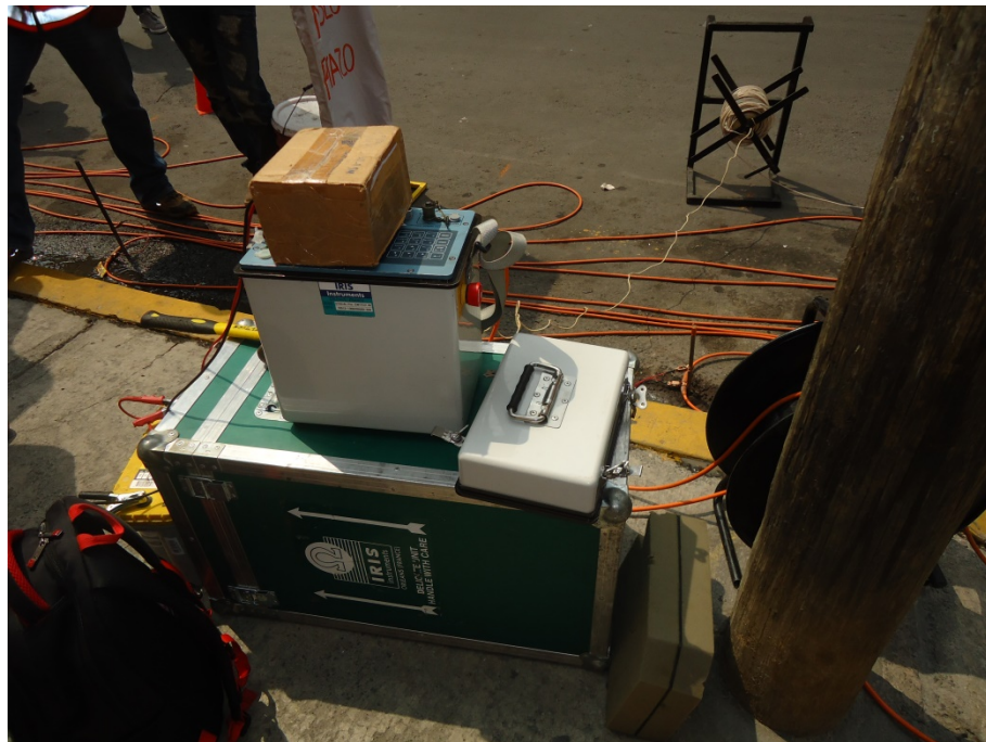
Figura 8. Se observa la consola SYSCAL Pro y el tendido del cable sobre la calle durante el levantamiento (19.3796° N, 99.2063° W. Calle: Benito Juárez).
