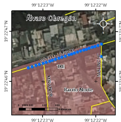
Figura 1. Croquis de localización del sitio con riesgo San Clemente y localización de la TRE (los puntos en color azul marcan la ubicación de los electrodos).
