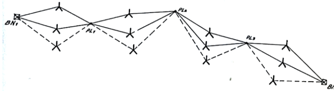
Figura 55. Nivelación por el método de doble puesta de aparato.
