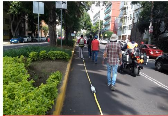
PROSPECCIÓN CON GPR ANTENA RTA DE 30MHZ .
