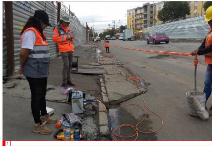
LÍNEA DE TOMOGRAFÍA ELÉCTRICA DE 115 MTS Y 22 METROS DE PROFUNDIDAD EFECTIVA
