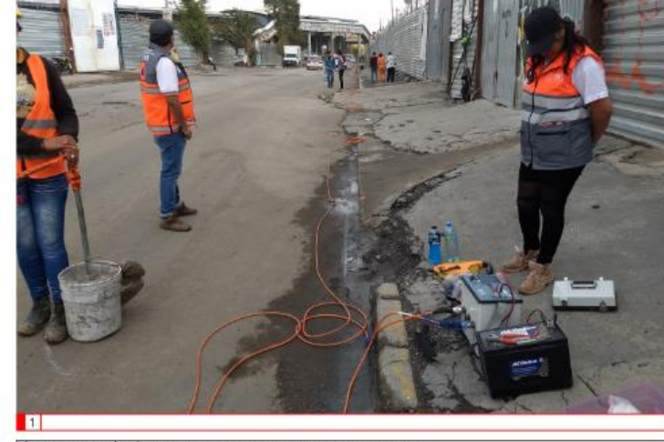
LÍNEA DE TOMOGRAFÍA ELÉCTRICA DE 115 MTS Y 22 METROS DE PROFUNDIDAD EFECTIVA
