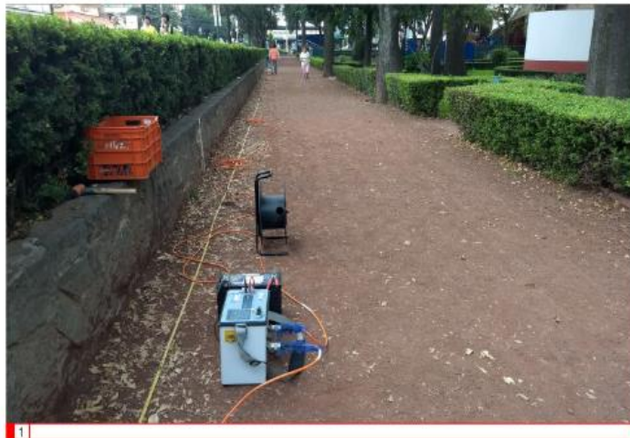
LÍNEA DE TOMOGRAFÍA ELÉCTRICA DE 115 MTS Y 22 METROS DE PROFUNDIDAD EFECTIVA
