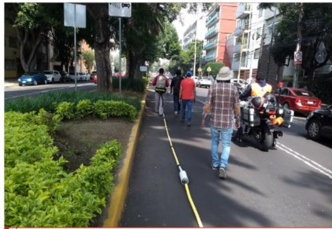
PROSPECCIÓN CON GPR ANTENA RTA DE 30MHZ .
