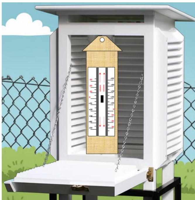
Figura 1. Representación gráfica de un termómetro instalado en un estación climatológica Fuente: Elaboración propia
