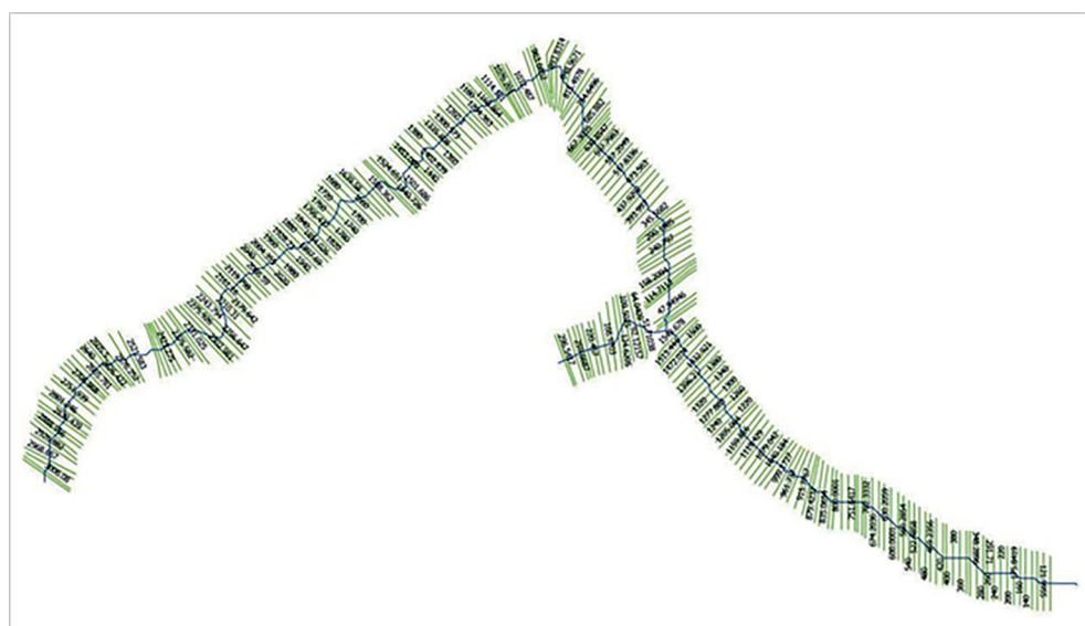
Imagen 17. Geometría del cauce a simular Fuente: Elaboración propia, con base en HEC-RAS
